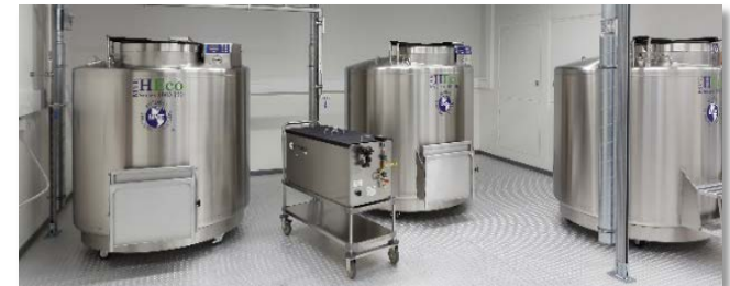
Probenlagerung in der Gasphase von flüssigem Stickstoff
