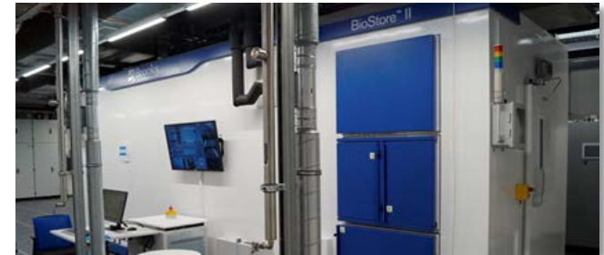
Probenlagerung bei -80°C im automatisierten Lagerroboter
